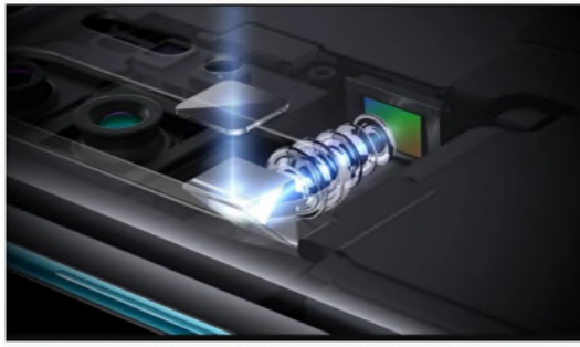
▲單稜式鏡頭透過將光線轉90度的方式，避免了色散鏡頭在手機上過於晃動的問題
